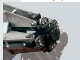
Зажимное устройство с ступенчатой системой фиксации позволяют зажимать диски с минимальным внутренним диаметром в 90 мм без необходимости использования аксессуаров.
