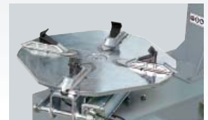
10"-18" / 10"-20" / 11"-22" Рабочий стол в стандартном исполнении позволяет эксплуатацию станда в вышеуказанном диапазоне размеров шин.
