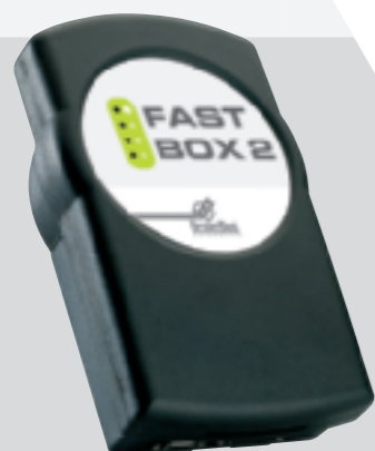
EOBD Счётчик числа оборотов и датчик температуры
