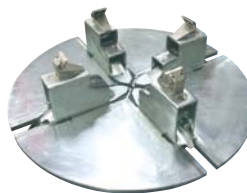
G84A7 (4 x набор) → 18"-20"-22" Комплект 4 шт) быстросъёмных насадок на кулачки. УвеличиваютП максимальный диаметр диска, зажимаемого на станке снаружи, на +2" от 17.5" до 19.5" (фургоны и коммерческие автомобили)
