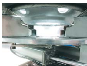
G84A7 (4 x набор) → 18"-20"-22" Комплект 4 шт) быстросъёмных насадок на кулачки. УвеличиваютП максимальный диаметр диска, зажимаемого на станке снаружи, на +2" от 17.5" до 19.5" (фургоны и коммерческие автомобили)
