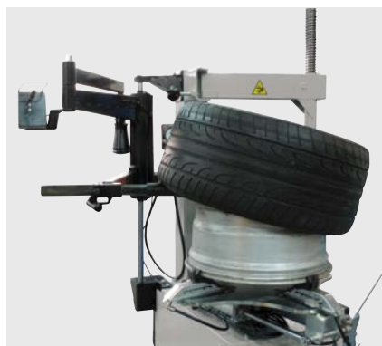
PLUS91N Устройство для работы с низкопрофильными шинами, “Третья рука” с дополнительным вращающимся диском, для полуавтоматических шиномонтажных стандов
