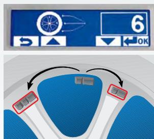
Программа скрытых весов производящая разбивку весов при дисбалансе колеса.
