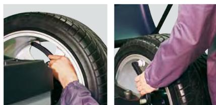
Автоматическое измерение колесного вылета и диаметра, для максимального размера колеса до 26", при помощи цифровой риски, оснащенной оптическим считывающим устройством.
