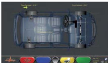
Быстрая диагностика геометрии кузова путём измерения геометрии по четырем точкам подвески, т.е. смещения передней и задней осей, позволяет определить отклонения в симметрии шасси и нарушения геометрии подвески автомобиля. В случае нарушения геометрии кузова компьютер наглядно покажет «красным» разницу между оригинальными размерами и смещённой частью кузова.
