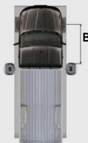
С каждой стороны платформы можно установить по два кронштейна быстрой фиксации измерительных блоков.
