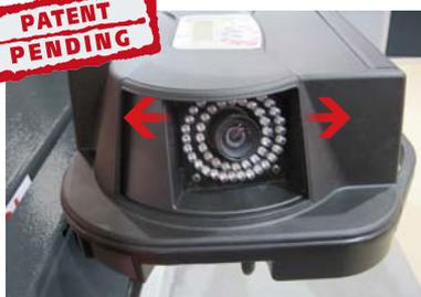
Наличие системы автоматического позиционирования, которая контролирует положение камер в горизонтальной плоскости. (Патент SPACE)
