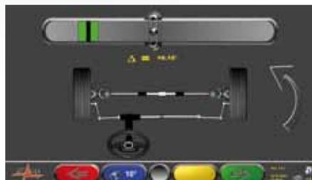
Процедура руления осуществляется с помощью электроники, для снятия показателей углов Caster (Продольный наклон оси поворота) и King Pin (поперечный наклон оси поворота) с большей точностью.
