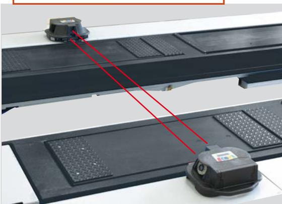
Автоматическая компенсация уровня платформ подъемника, продольные и поперечные изменения подъемника на любой высоте гарантируя максимальную точность.
