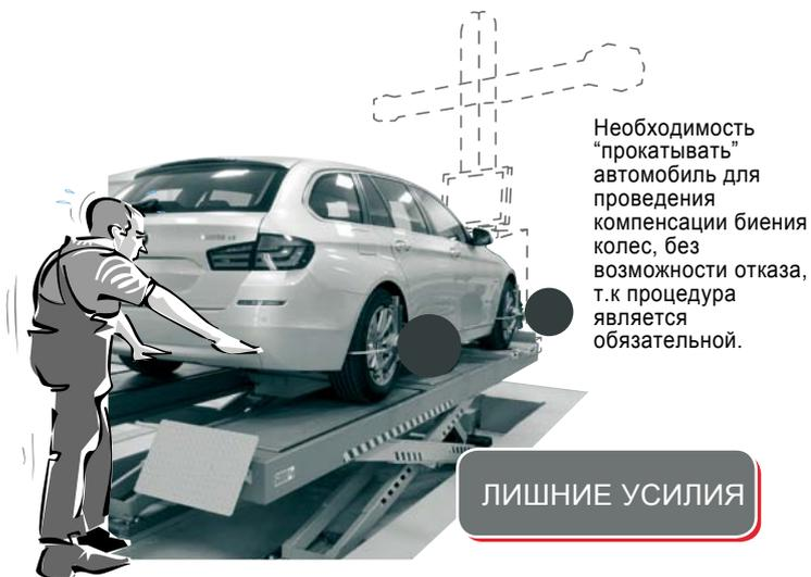
Необходимость "прокатывать" автомобиль для проведения компенсации биения колес, без возможности отказа, т.к процедура является обязательной.
