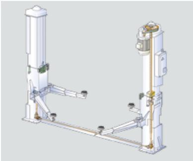
Trasmissione fra le colonne tramite barra rotante.
