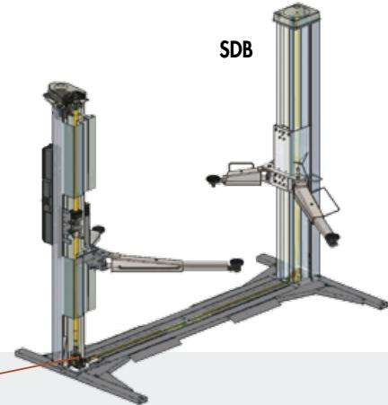
L'esclusivo ponte con pedana portante-installazione possibile anche su pavimenti che non garantiscono un ancoraggio al suolo sicuro. Trasmissione fra le colonne tramite barra rotante e scatole angolari con ingranaggi conici a bagno d'olio che non richiedono alcuna manutenzione.
